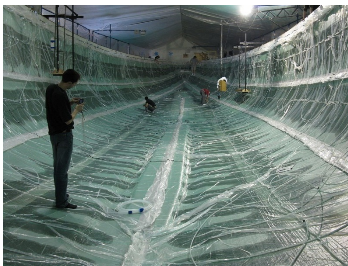
Figure 13. – Photo de l'infusion d'une coque d'un bateau de plus de 50m en PRFC.
