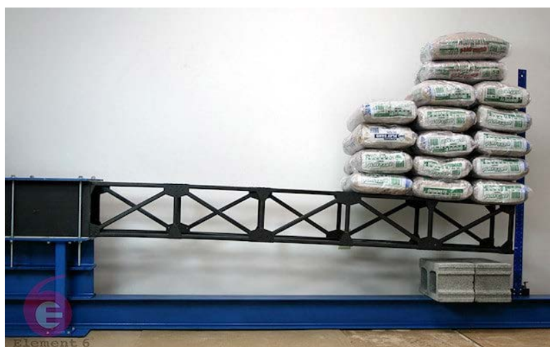
Figure 12. – Photo d'un test de résistance d'une poutre treillis composée d'éléments de PRFC.
