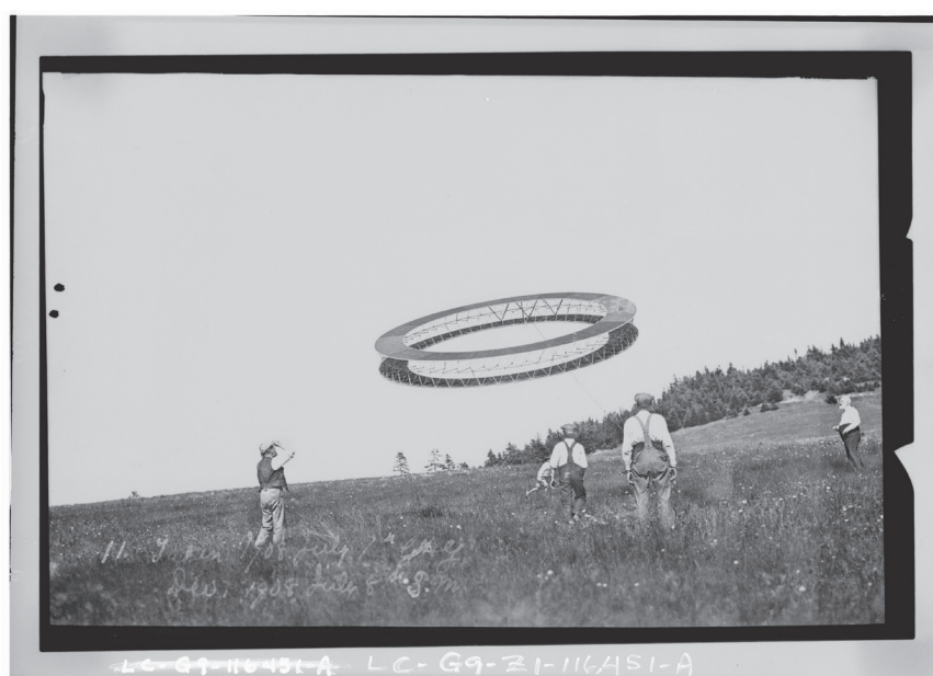
Fig. 3 : Cerf-volant à maille tétraédrique. Graham Bell (à droite sur la photo). 1908.
