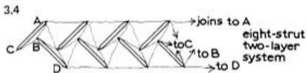
Fig. 10 : Principe de 'déroulage' d'une figure en diamant à deux colonnes. Pugh. 1976.
