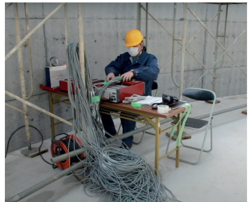
Fig. 29 : Mesure des contraintes par jauge électrique d'extensométrie 1
