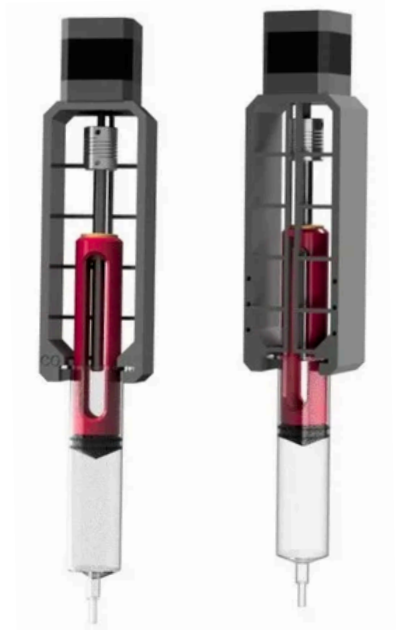
Figure 15. Représentation 3D de l'extrudeuse une fois assemblée
