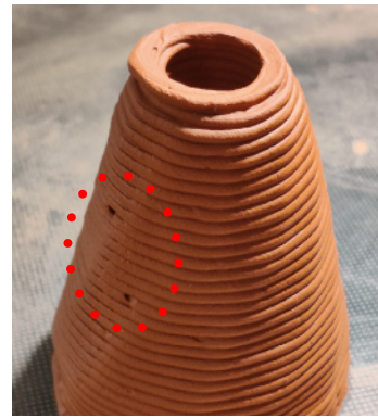
Image 57. Photo de fissures (en rouge) apparues après séchage
