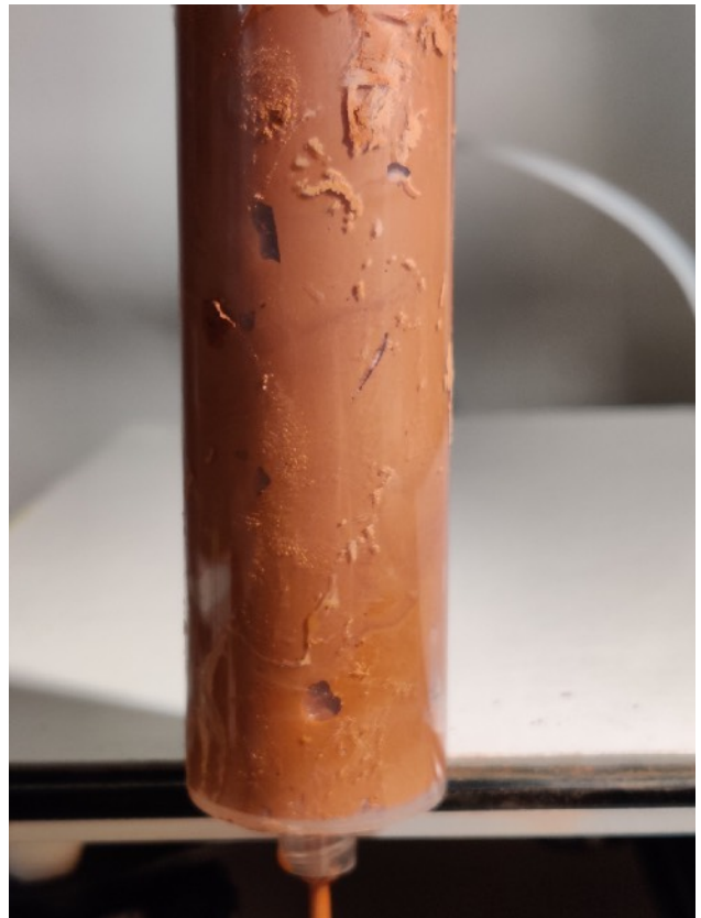
Image 41. Mise en évidence des bulles d'air dans la seringue
