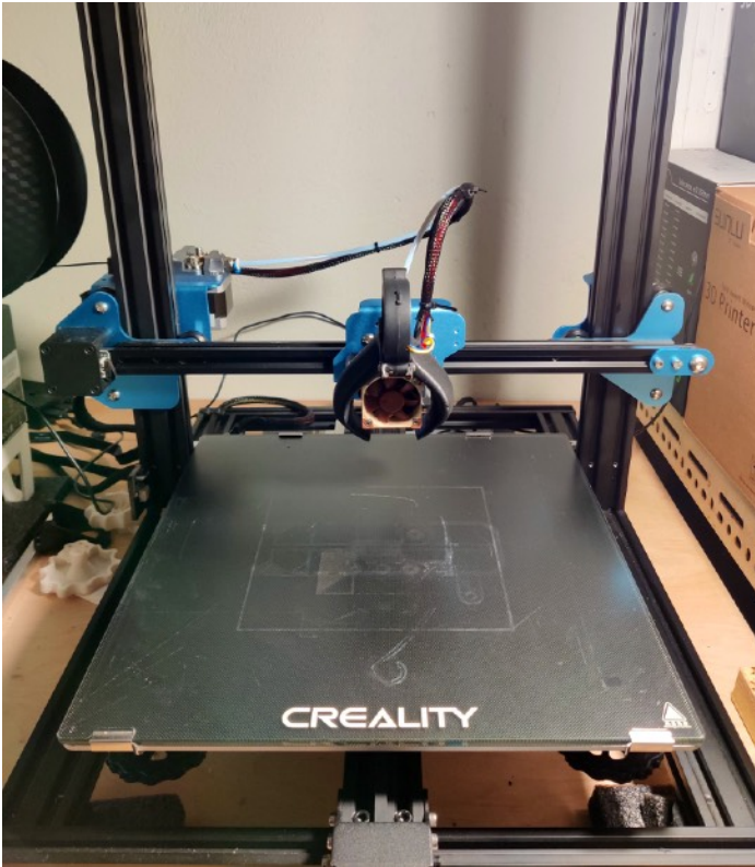
Image 38. Photographie de mon imprimante 3D avec l'extrudeuse d'origine
