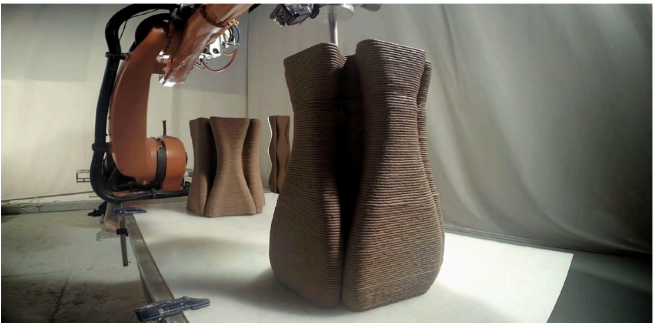
Image 21. Photo d'impression de colonnes en argile par bras robotisé - S. Giannakopolous à l'IAAC
