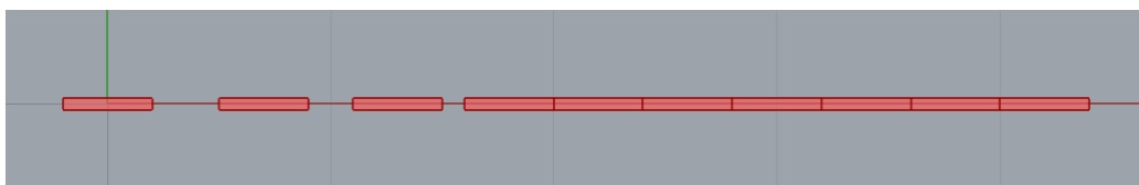
Figure 07.10 : 10 briques distancées de 0.7 m au départ, la distance diminue de 0.1 m à chaque orifice de droite à gauche (Source : auteur)
