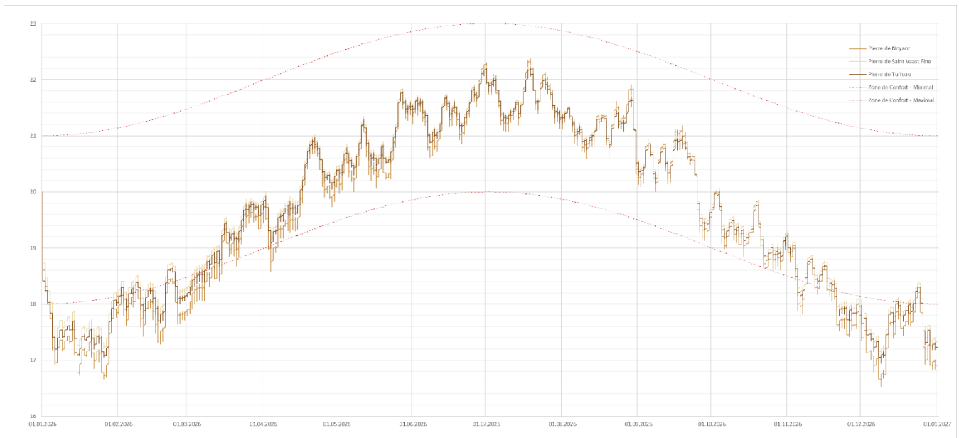
Figure 141 : Évolution de la température de la surface intérieure de différentes pierres sur une année entière à Rennes (Source : WUFI, Auteur)
