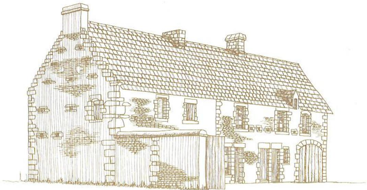
Figure 88 : Maison en pierre porteuse dans la plaine de Caen, Normandie (Source : MONDIN, 1979)
