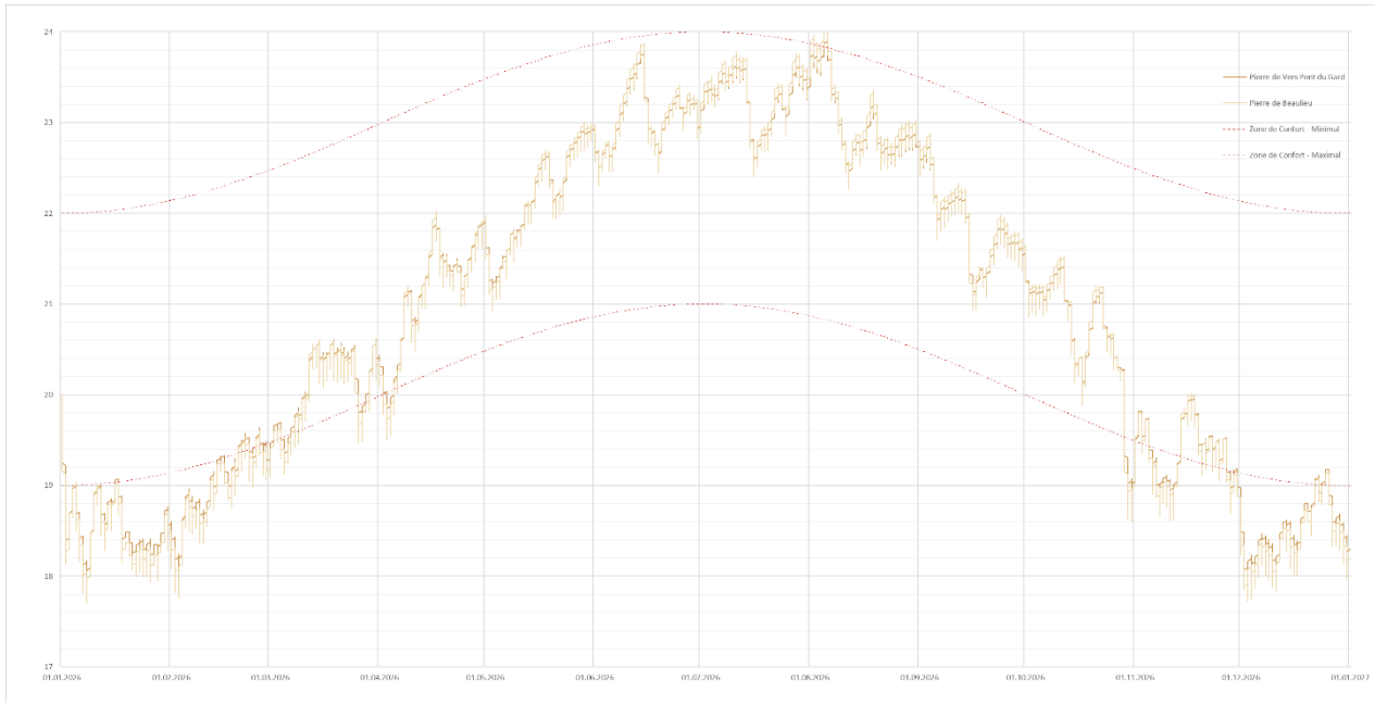
Figure 150 : Évolution de la température de la surface intérieure de différentes pierres sur une année entière à Marseille (Source : WUFI, Auteur)
