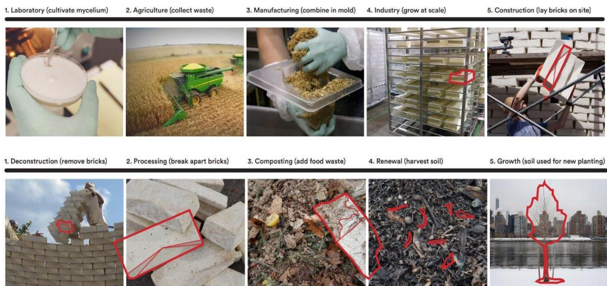
Fig. 3.2.h) Etapes en images du début et de la fin du cycle de vie de la brique de mycélium
