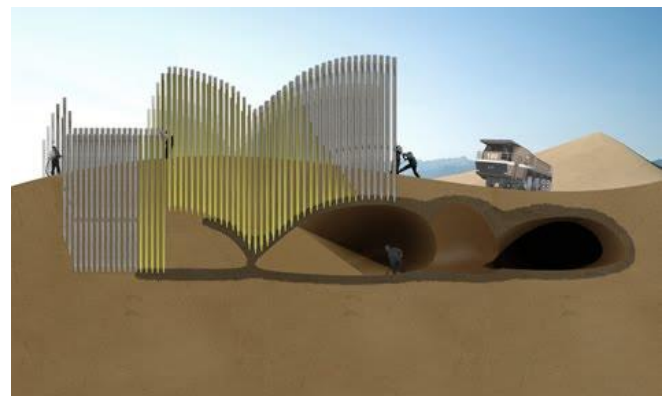
Fig. 3.2.k) Solidification des parties de la dune selon les besoins, grâce à des injections via des pieux.
