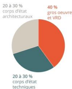
Fig. 1.1 e) Emissions de gaz à effet de serre dans la construction d'un bâtiment
