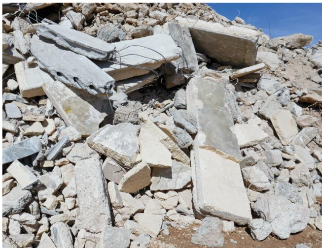
Fig. 3.1.a) Les éléments en béton provenant de démolitions et destinés à être recyclés sont très divers.
