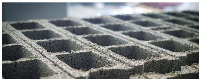
Fig. 1.3.a) Bloc de béton creux, composé d'alvéoles, avec deux extrémités creuses, garnies de joints verticaux. Celui étudié est posé au mortier à joints épais, la technique la plus répandue.
