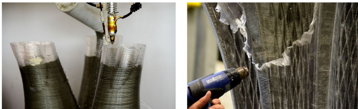
Figure Z : Processus de coffrage et d'impression - Processus de décoffrage
