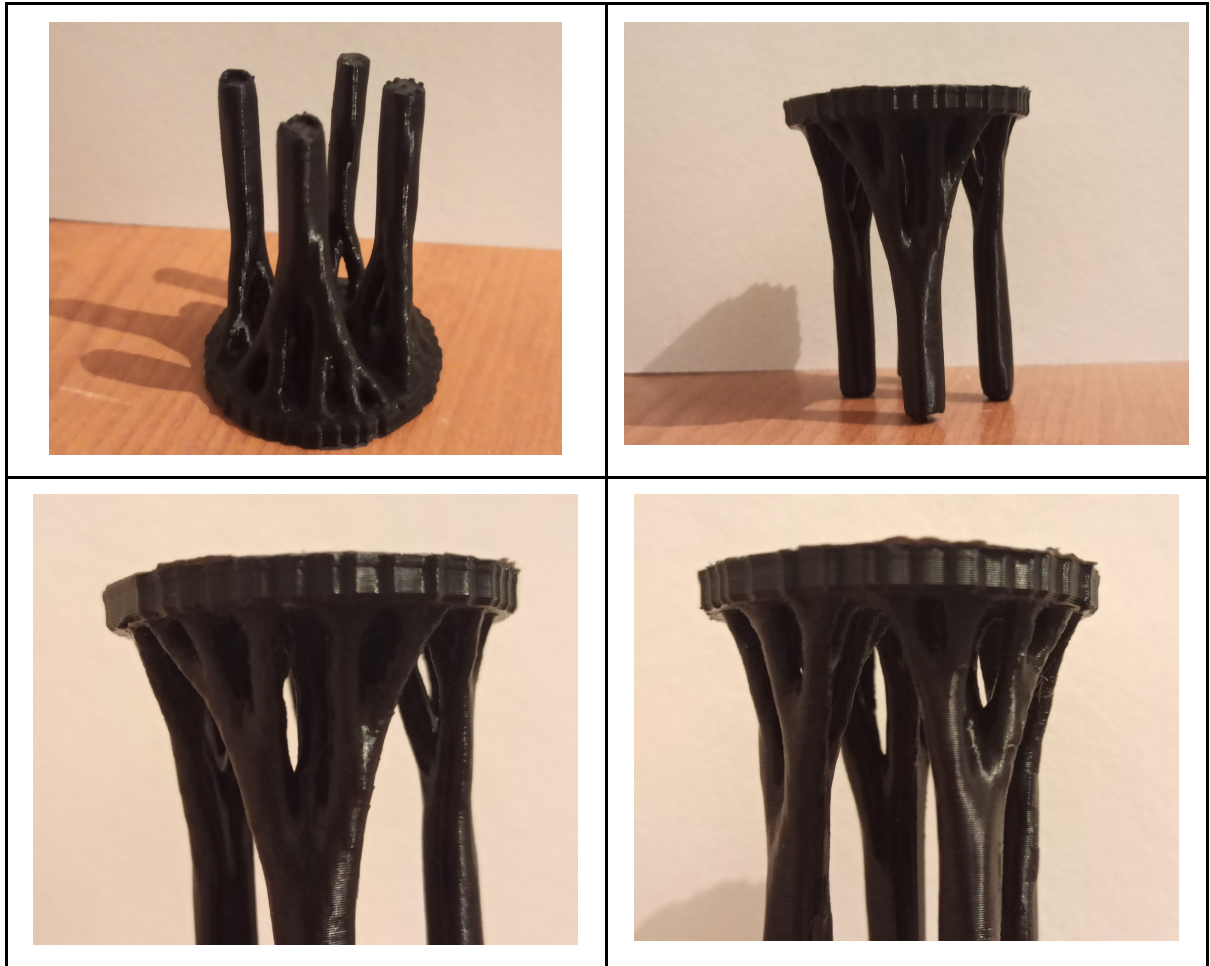
Optimisation et impression d'un tabouret avec support
