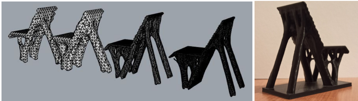
Imprime écran et Photographie de l'impact de la résolution sur la génération du modèle
